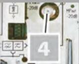
Die Verstärker VARIO 561 O, VARIO 662 O, VARIO 683 O und VARIO 684 O verfügen über 4 Messbuchsen. Am Eingang ist eine bidirektionale Messbuchse [16] (siehe Bild links) mit 20 dB Auskoppeldämpfung vorhanden, mit der Sie den Eingangspegel für den Vorweg und den Ausgangspegel für den Rückweg messen können.
